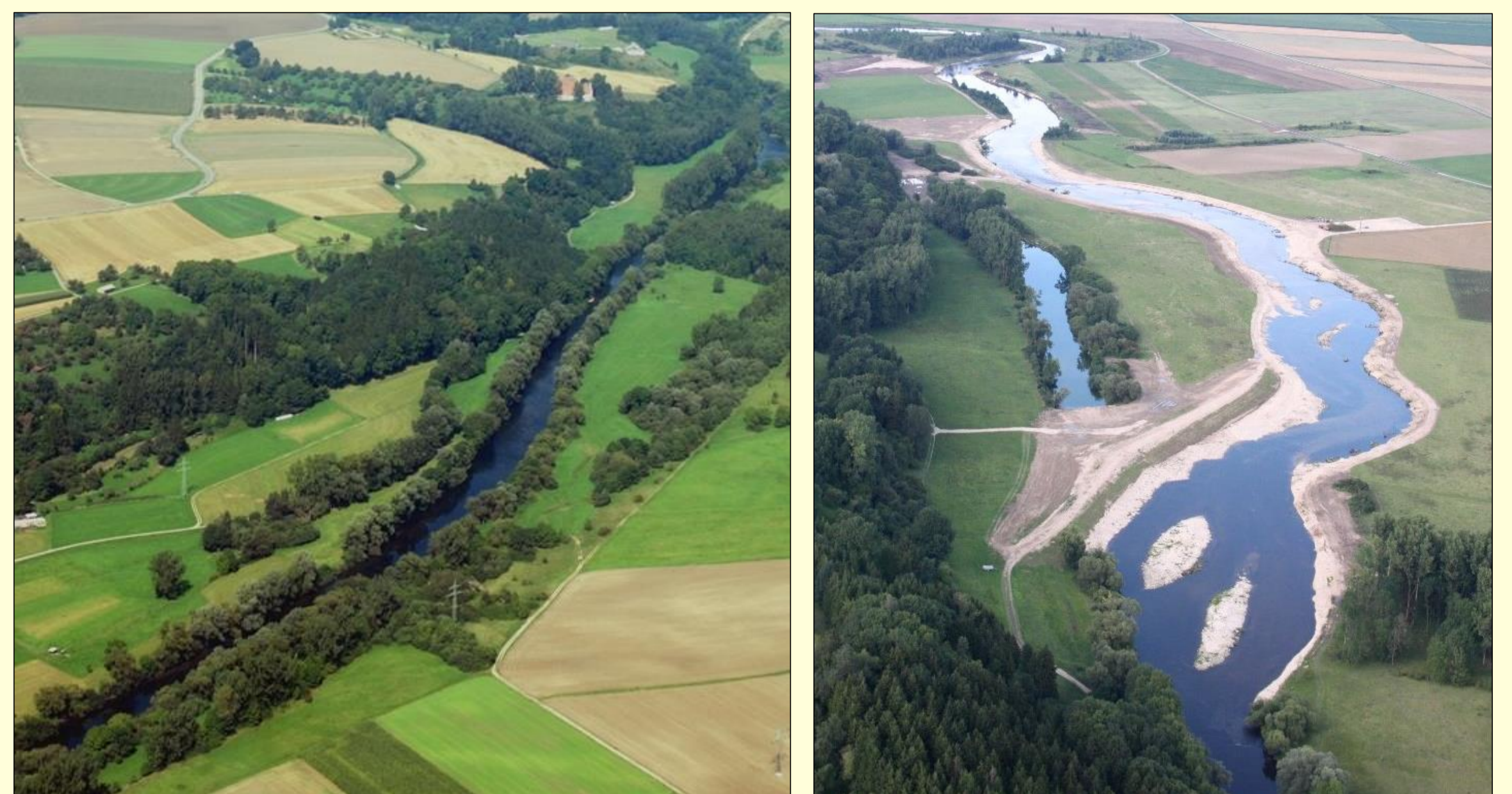
Abb. 3: Fließgewässerabschnitt der Donau vor (links) und nach der Umsetzung einer strukturverbessernden Maßnahme (rechts) (© RP Tübingen)
